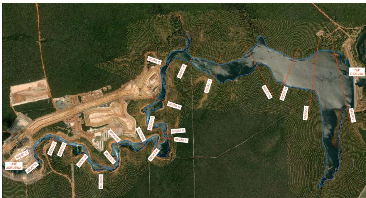
**Figura 16: UHE JURUENA - Estudos de Rompimento de Barragem - Localização das Seções Transversais utilizadas na Modelagem Hidráulica**
